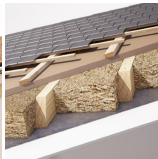
Toiture après rénovation (avec isolation)
