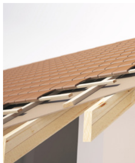
Toiture avant rénovation (sans isolation)
