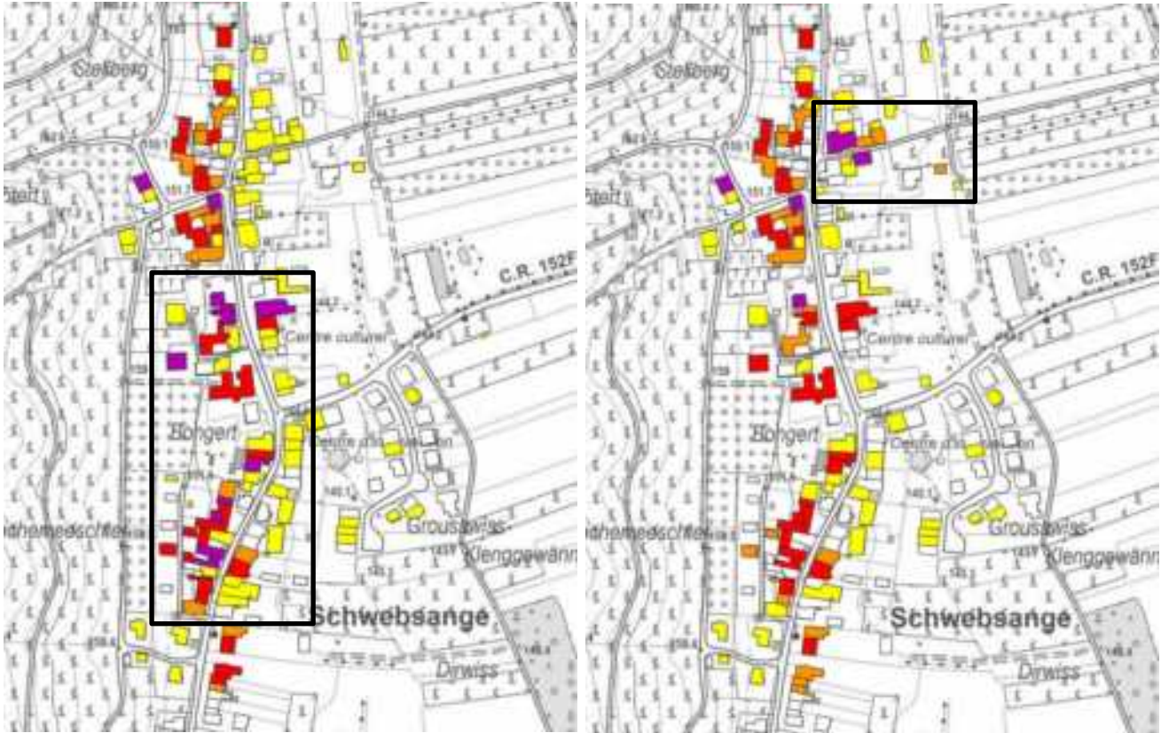
Abbildung 90: Gefährdung der Gebäude in Schwebsange bei T = 100 a, ohne Maßnahmen links und mit Maßnahmen rechts
